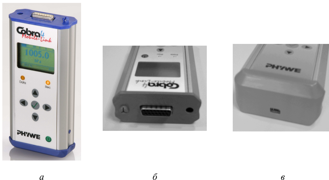
Рис. 7. Мобильный интерфейсный блок: а) передняя панель, б) 15-контактный разъем, в) USB-разъем
