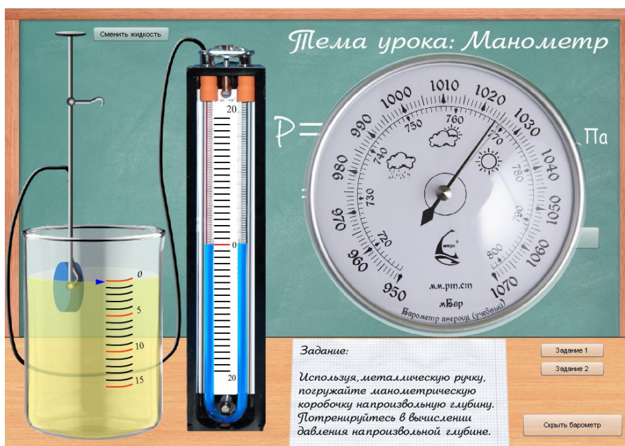
Рис. 8. Модель «Манометр». Измерение давления внутри жидкости манометром и атмосферного давления барометром-анероидом
