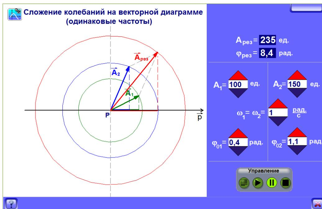
Рис. 3. Иллюстрация процедуры сложения колебаний с одинаковой частотой и различными фазами на модели (из состава среды «Интер@ктивная физика») [1]
