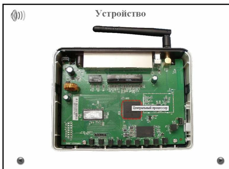
Рис. 3. Устройство беспроводной точки доступа Wi-Fi
