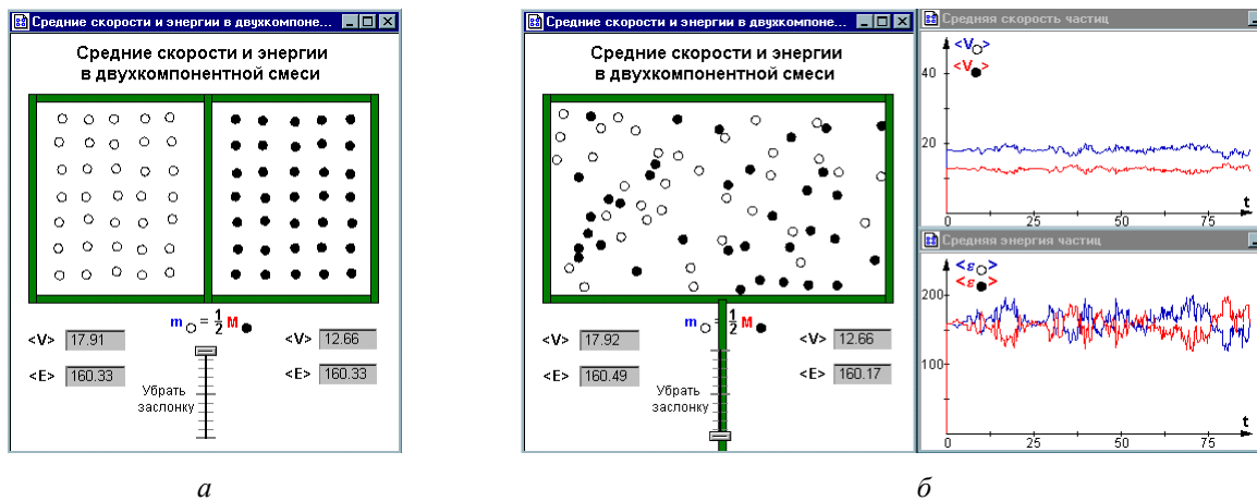
Рис. 10. Перемешивание частиц двух сортов (а, б) при равной начальной средней энергии
