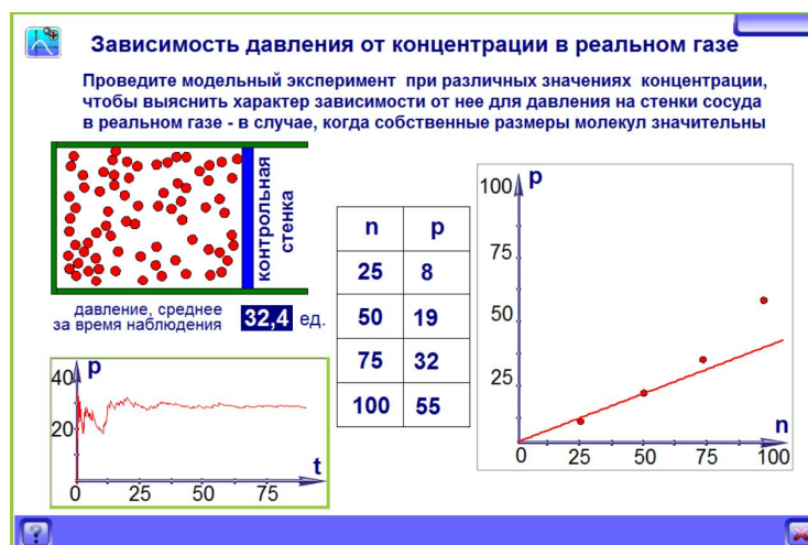
Рис. 16. Зависимость давления от концентрации при увеличенных размерах частиц
