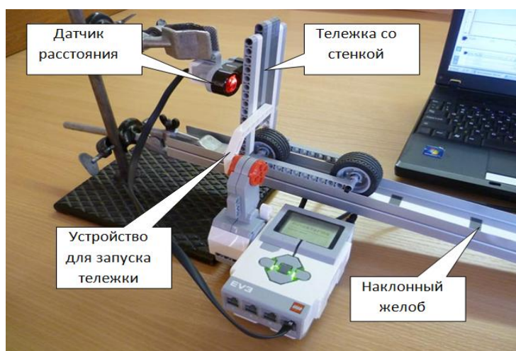
Рис. 12. Общий вид экспериментальной установки для исследования зависимости расстояния, пройденного тележкой, от времени движения [6, с. 402]
