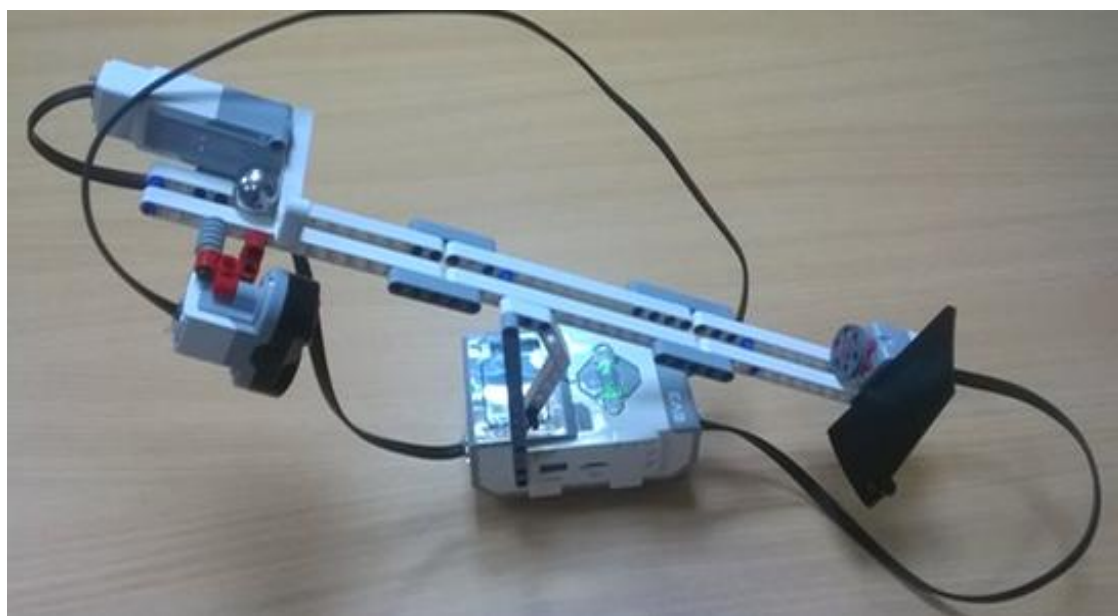
Рис. 7. Общий вид установки для определения ускорения, собранной на базе конструктора Lego Mindstorms NXT (вариант 4)
