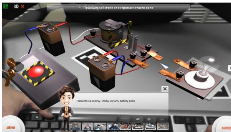
Рис. 12. Принцип действия электромагнитного реле (функция AV – дополненная реальность). Образовательный комплекс по физике «Увлекательная реальность» [10]
